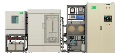
図2 減圧蒸気スweep型のCO 2 膜分離装置モデル図。
