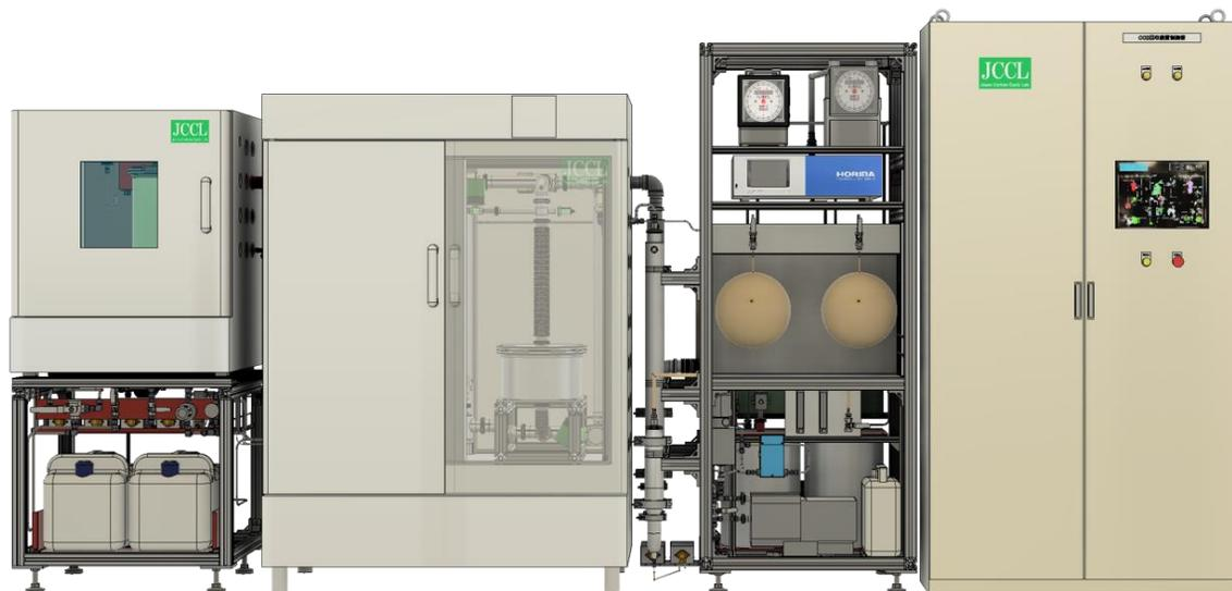
VPSAシリーズは、固体吸収剤によりCO<sub>2</sub>を吸収し、次いで固体吸収剤に減圧蒸気を供給することでCO<sub>2</sub>を分離・濃縮するCO<sub>2</sub>回収装置です。
